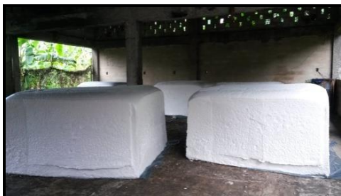
Blocs de mousse sortant du four (polymérisation)
